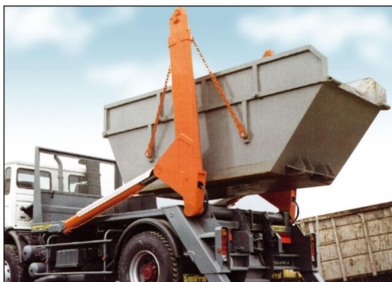
Benne étanche de collecte des plastiques et bois, pour préserver l'intégrité des sols
